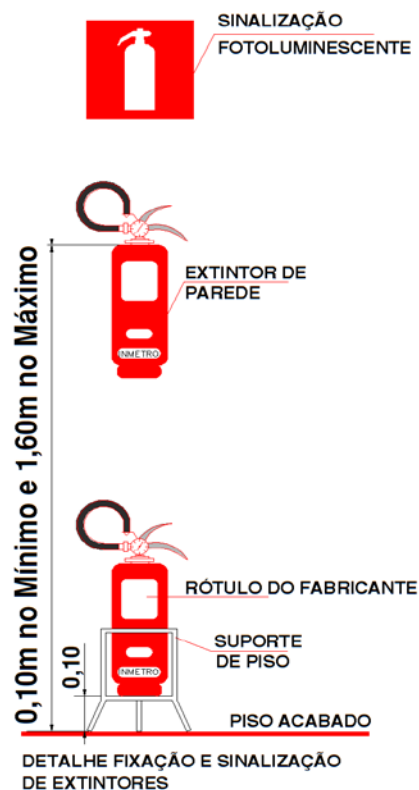
Figura 1 - Fixação de extintor
